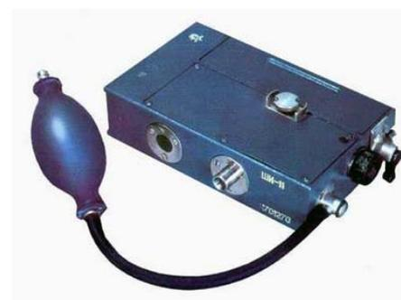
На рис 19.3 изображён шахтный интерферометр, который используют для определения процентного содержания метана и углекислого газа в рудничном воздухе действующих проветриваемых горных выработок. Действие прибора основано на измерении смещения интерференционной картины, происходящего вследствие изменения состава исследуемого воздуха, который находится на пути одного из двух лучей, способных интерферировать.
