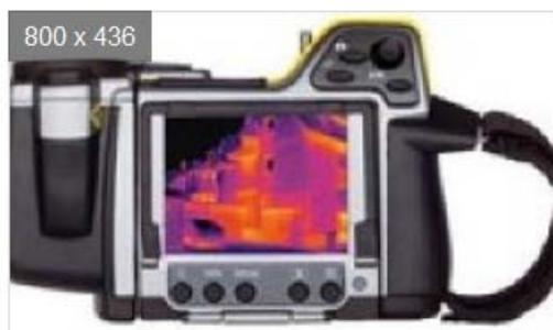
Различают **наблюдательные** и **измерительные** тепловизоры. Первые просто делают изображение в инфракрасных лучах видимым в той или иной цветовой шкале. Измерительные тепловизоры, кроме того, присваивают значению цифрового сигнала соответствующую ему температуру, в результате чего получается картина распределения температур.
