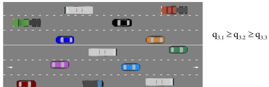
Рисунок 6 – Формирование условий движения ПМТ на шестиполосном перегоне улично-дорожной сети, где зависимость скорости потока от плотности определяется на трех полосах движения
