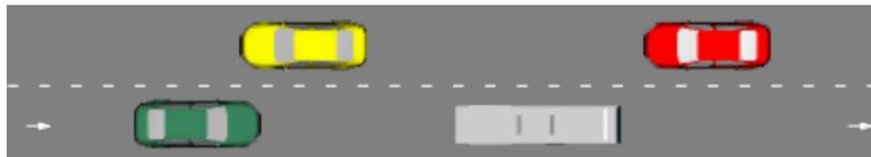
Рисунок 4 – Формирование условий движения ПМТ на двухполосном перегоне УДС, где зависимость скорости потока от плотности определяется одной полосой движения
