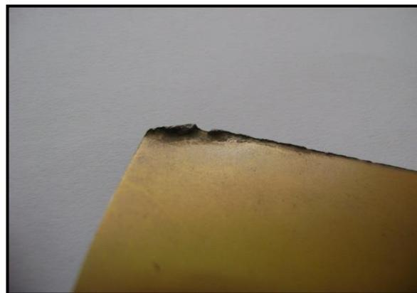
Рис. 3. Общий вид заусенца по задней кромке пера лопатки
