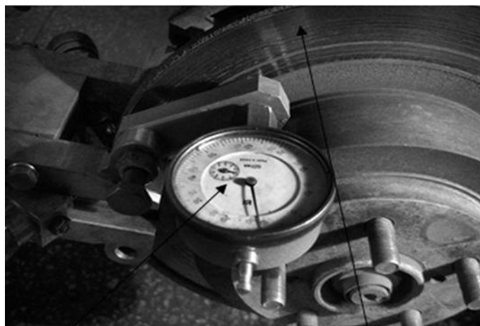
Рисунок 6 – Измерение биения тормозного диска на автомобиле
