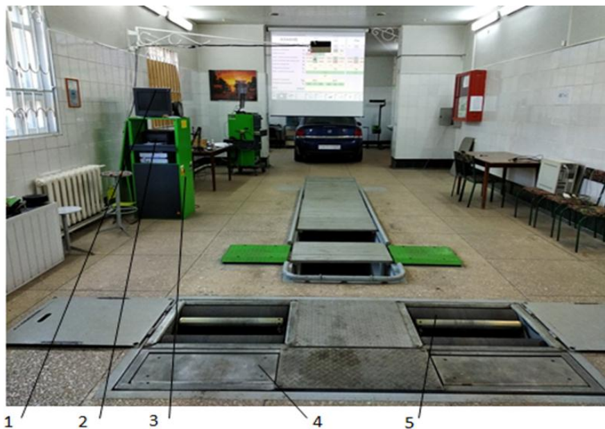
1 – монитор; 2 – принтер; 3 – стойка с АЦП; 4 – площадка для взвешивания автомобиля; 5 – опорно-приводное устройство тормозного стенда Рисунок 1 – Линия диагностики BOSCH SDL 260
