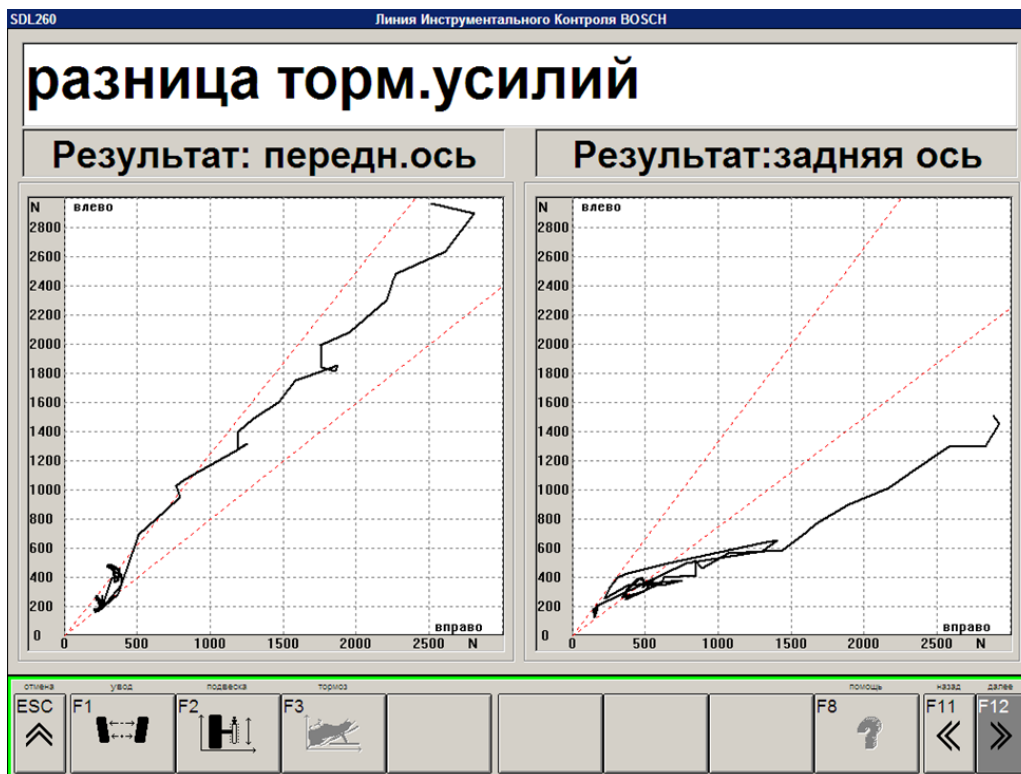
Рисунок 5 – График разницы тормозных сил во времени на передней и задней осях автомобиля
