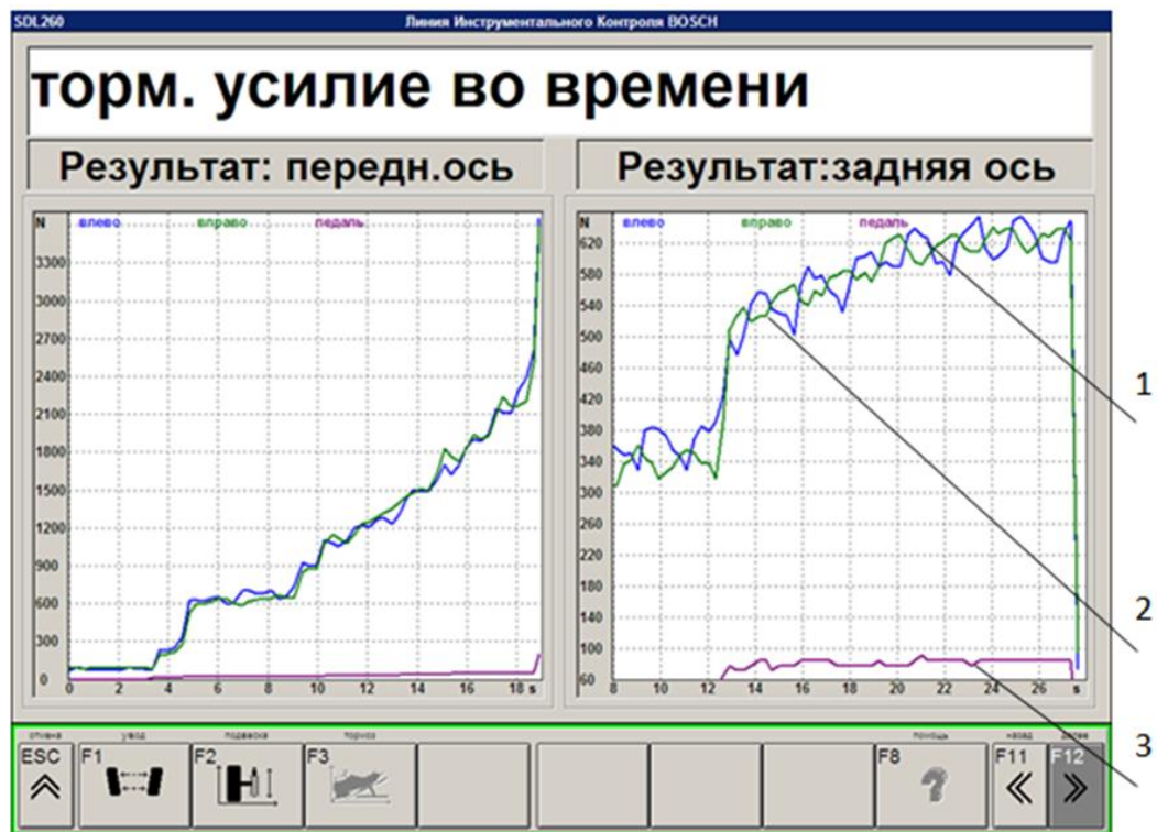
Рисунок 4 – График изменения тормозных сил во времени на передней и задней осях автомобиля
