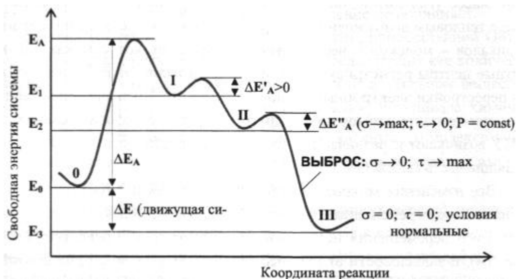
Рисунок 5.2 - Возможный сценарий изменения свободной энергии частицы ОМУ , участвующей в процессе превращений:
