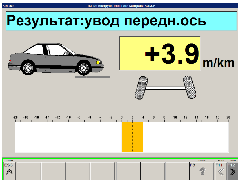
Рисунок 19. – Окно с результатом увода колес передней оси
