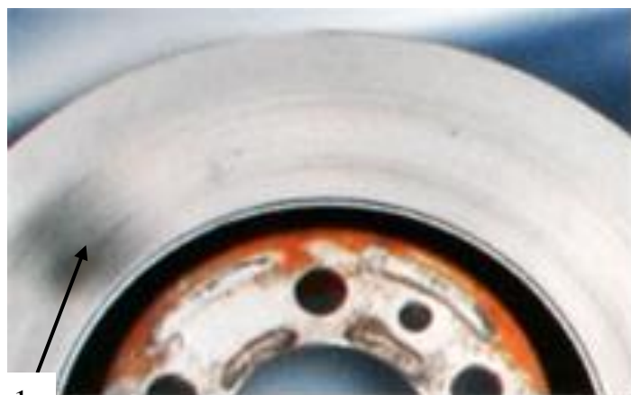
Рисунок 41. – Радиальное биение тормозного диска 1 – место биения тормозного диска.
