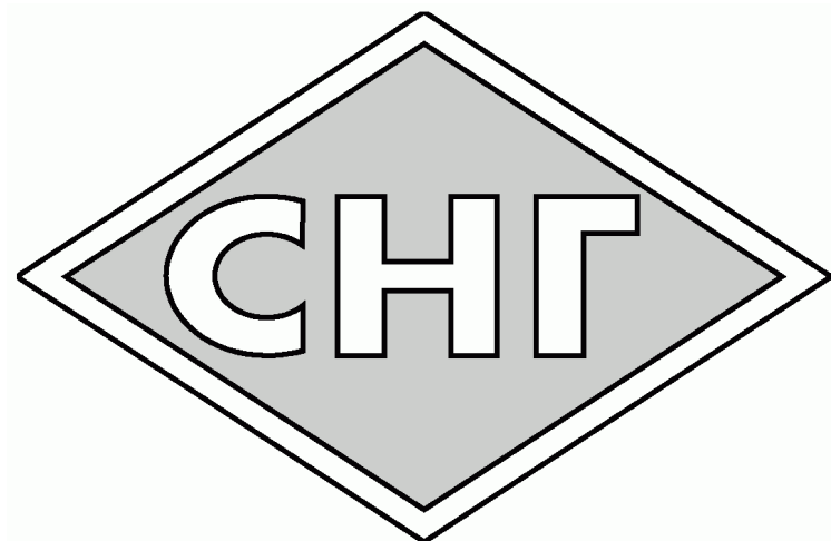
Рисунок 9. – Образец опознавательного знака КТС категорий М 2 и М 3 , использующих в качестве топлива сжиженный нефтяной газ
