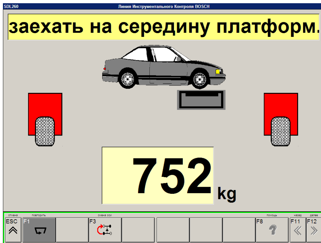
Рисунок 25. – Установка автомобиля на платформу тестера
