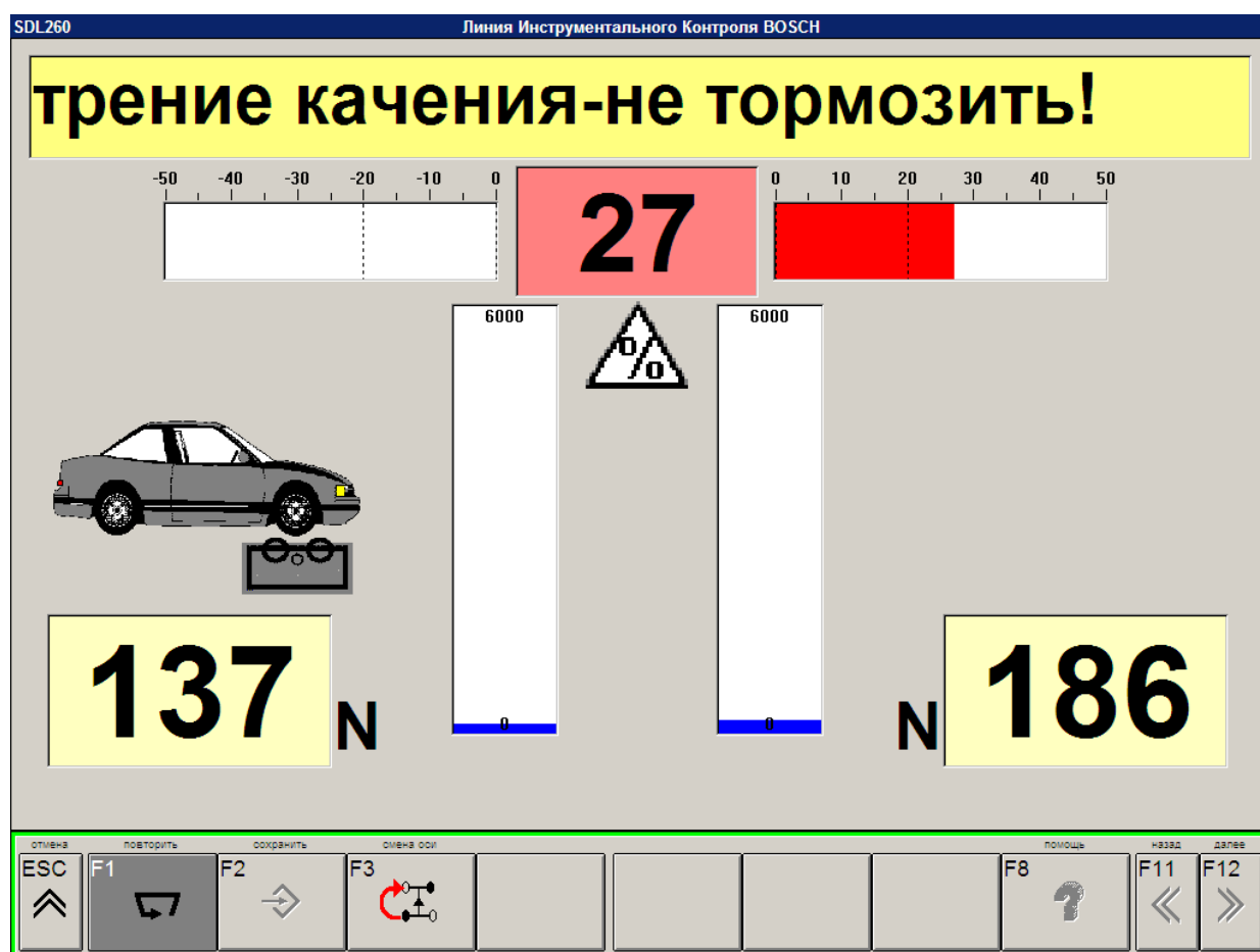
Рисунок 32. – Измерение сопротивления качения колес передней оси
