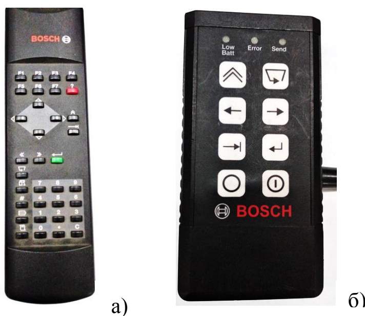
Рисунок 24. а) Пульт дистанционного управления; б) Инфракрасный пульт-передатчик датчика усилия на тормозной педали
