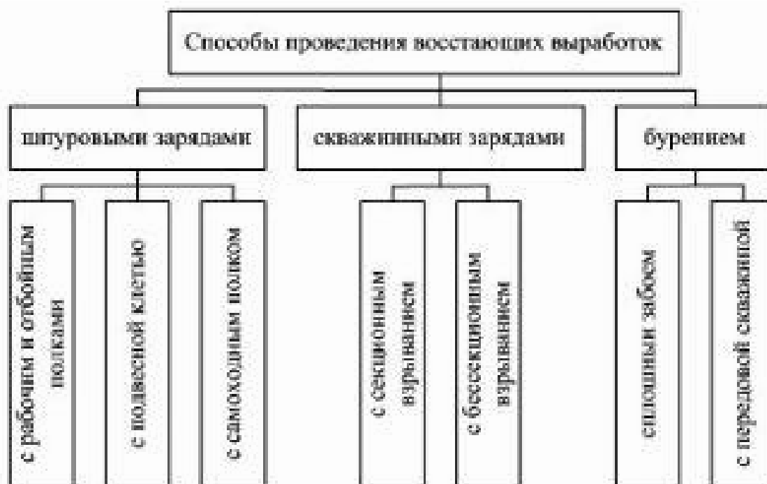
Рисунок 8.1 – Способы проведения восстающих выработок
