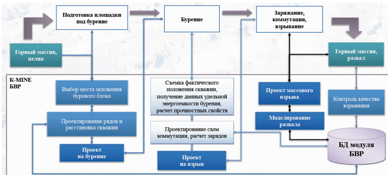
Рисунок 4.2 – Полный цикл проектирования и управления буровзрывными работами в карьере
