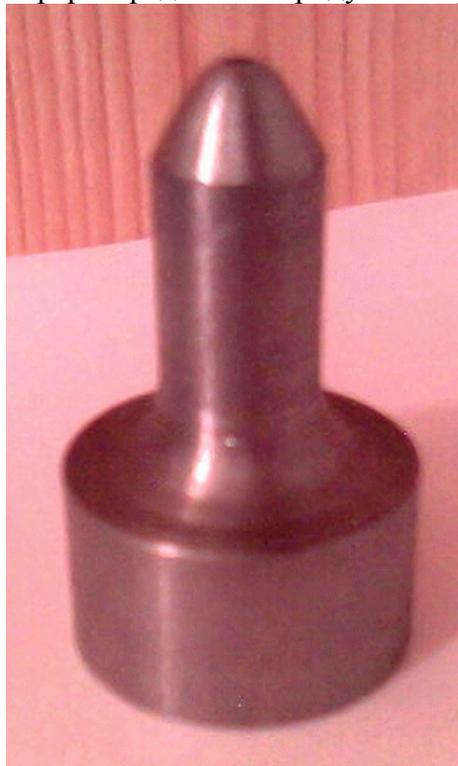
Рисунок 13.2 -Рефрактор для осесимметричного перераспределения импульса взрыва
