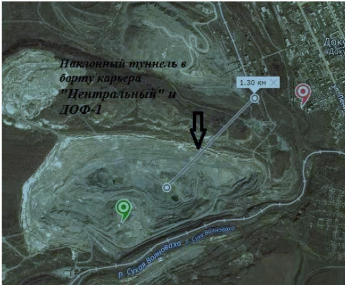
Рисунок 2.4 – Комбинированная схема вскрытия карьера «Центральный» ДФДК
