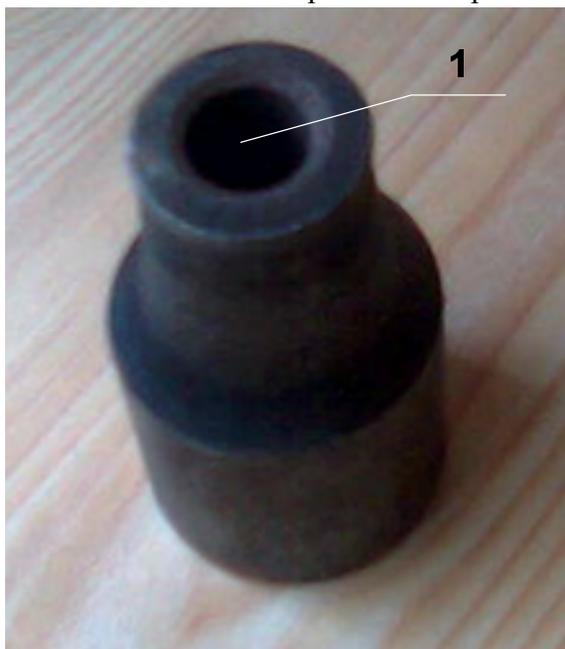
Рисунок 13.3 - Рефрактор для скважинного заряда на контакте пород разной прочности: 1 – осевой канал
