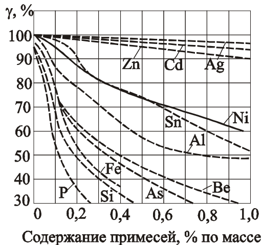
Рис.5.2 Зависимость удельной проводимости \gamma меди от содержания примесей (в % по массе)
