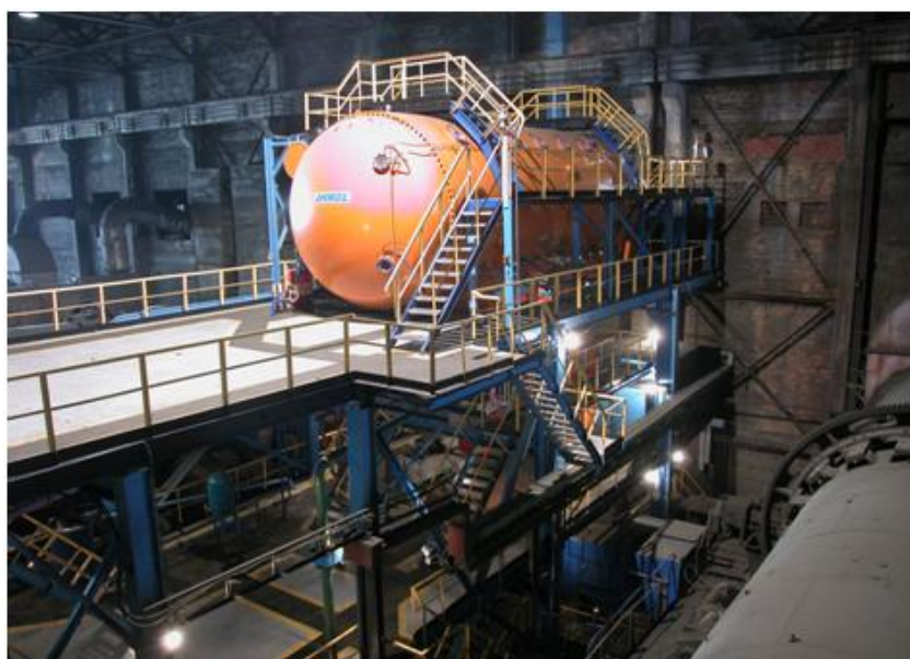
Рис. 4.7. Компоновка напорного фильтра HBF
