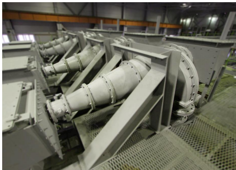
Рис. 9.7. Низконапорные гидроциклоны большого диаметра и производительности
