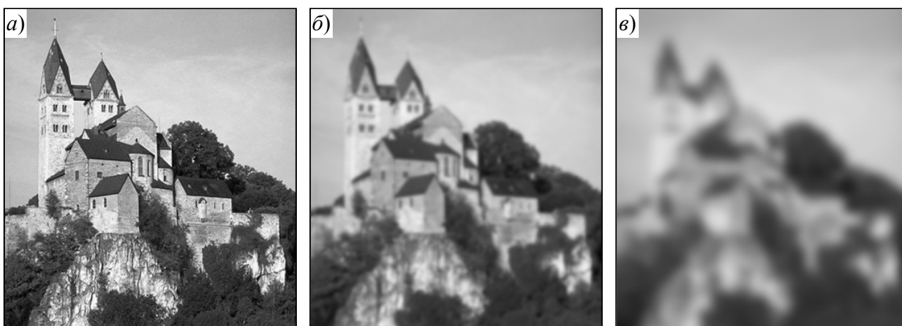
Рисунок 5.10 – Фильтр размытия Гаусса: исходное изображение (а), \sigma = 2 (б) и \sigma = 6 (в)
