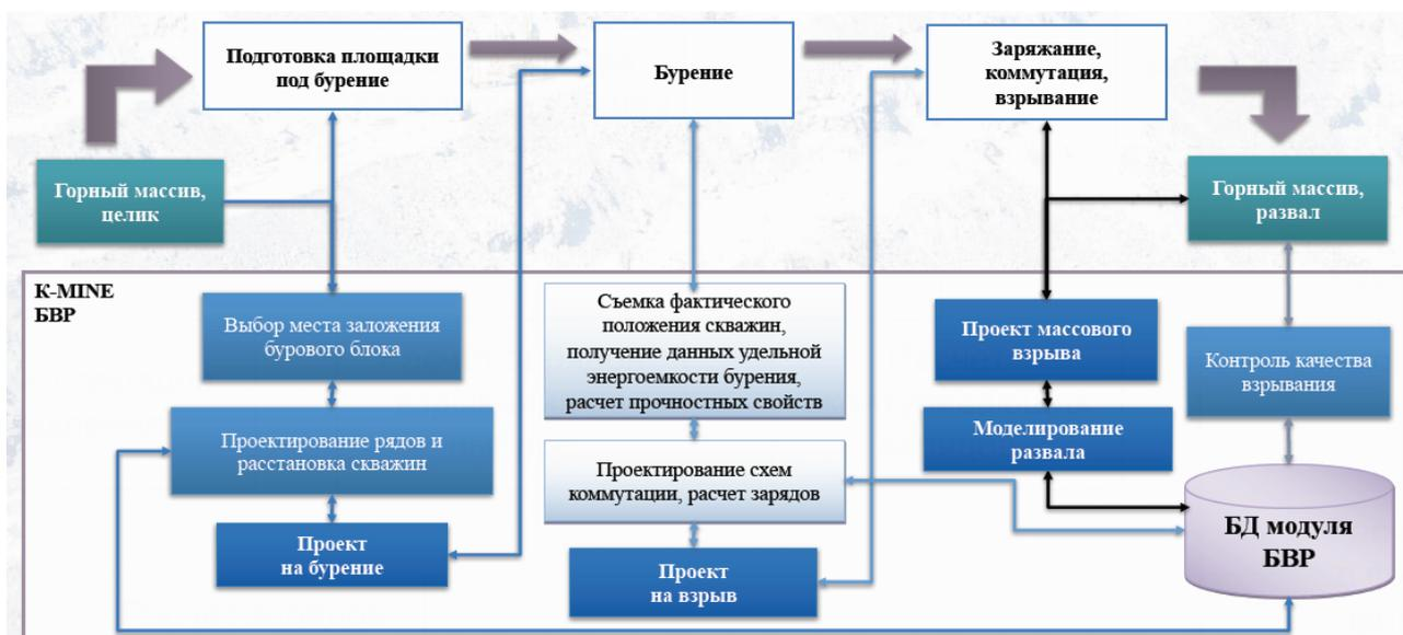
Рисунок А.2 – Полный цикл проектирования и управления буровзрывными работами в карьере
