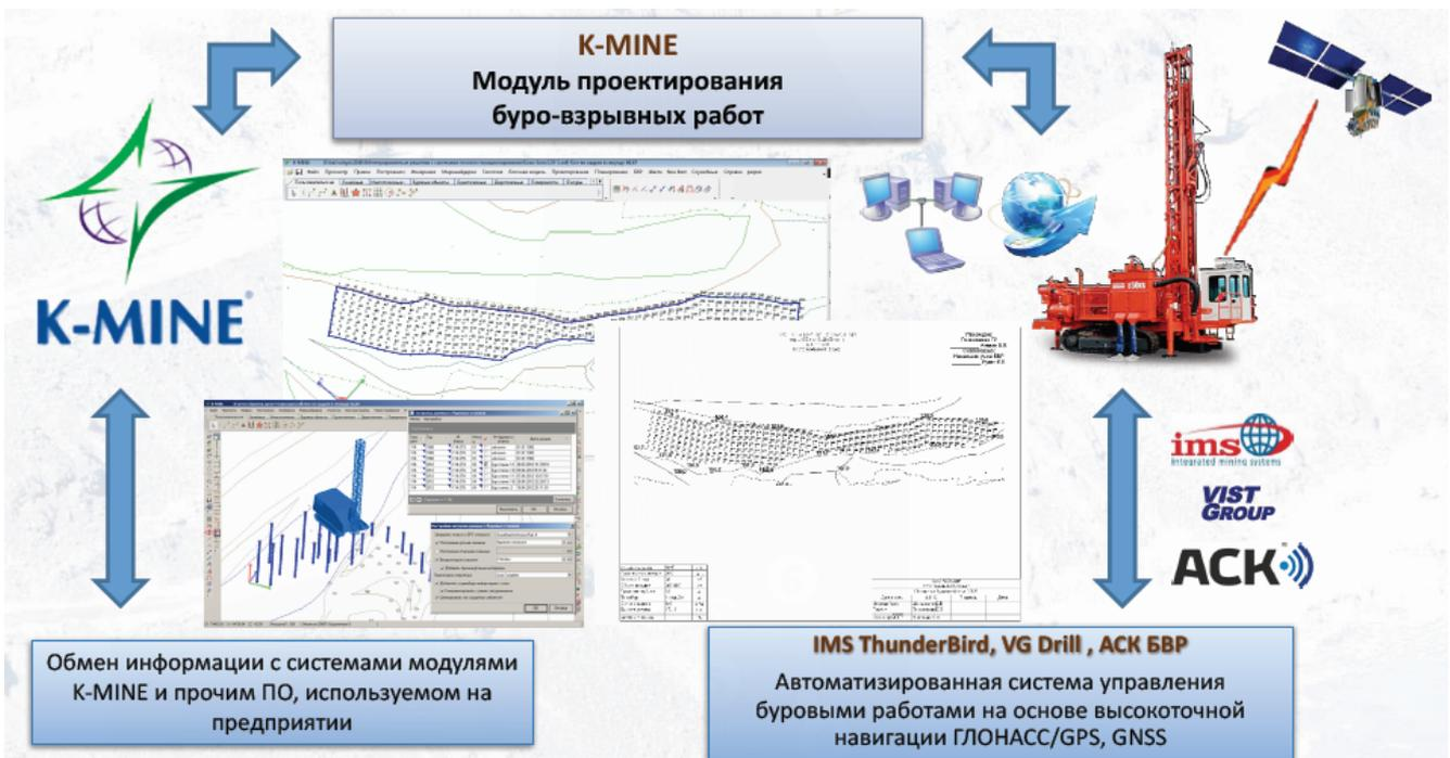
Рисунок А.4 – Интеграция с системой точного позиционирования бурового оборудования
