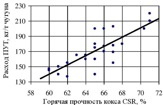
Рис. 1. Зависимость удельного расхода ПУТ от горячей прочности кокса: точки – экспериментальные значения по данным работы [15]
