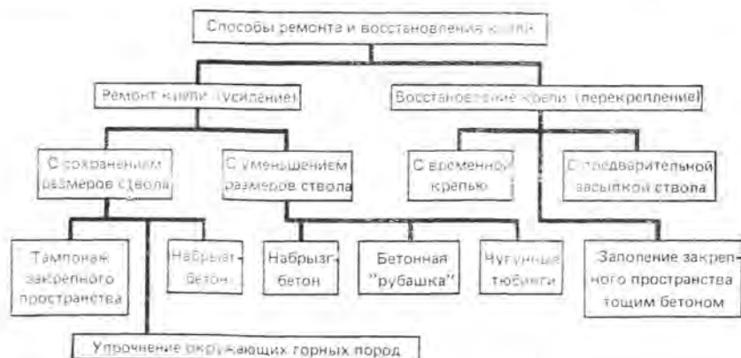
Рис. 5.2. Способы ремонта и восстановления крепи
