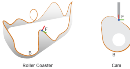
Рисунок 1.40 — Пример применения ограничения движение точки по кривой
