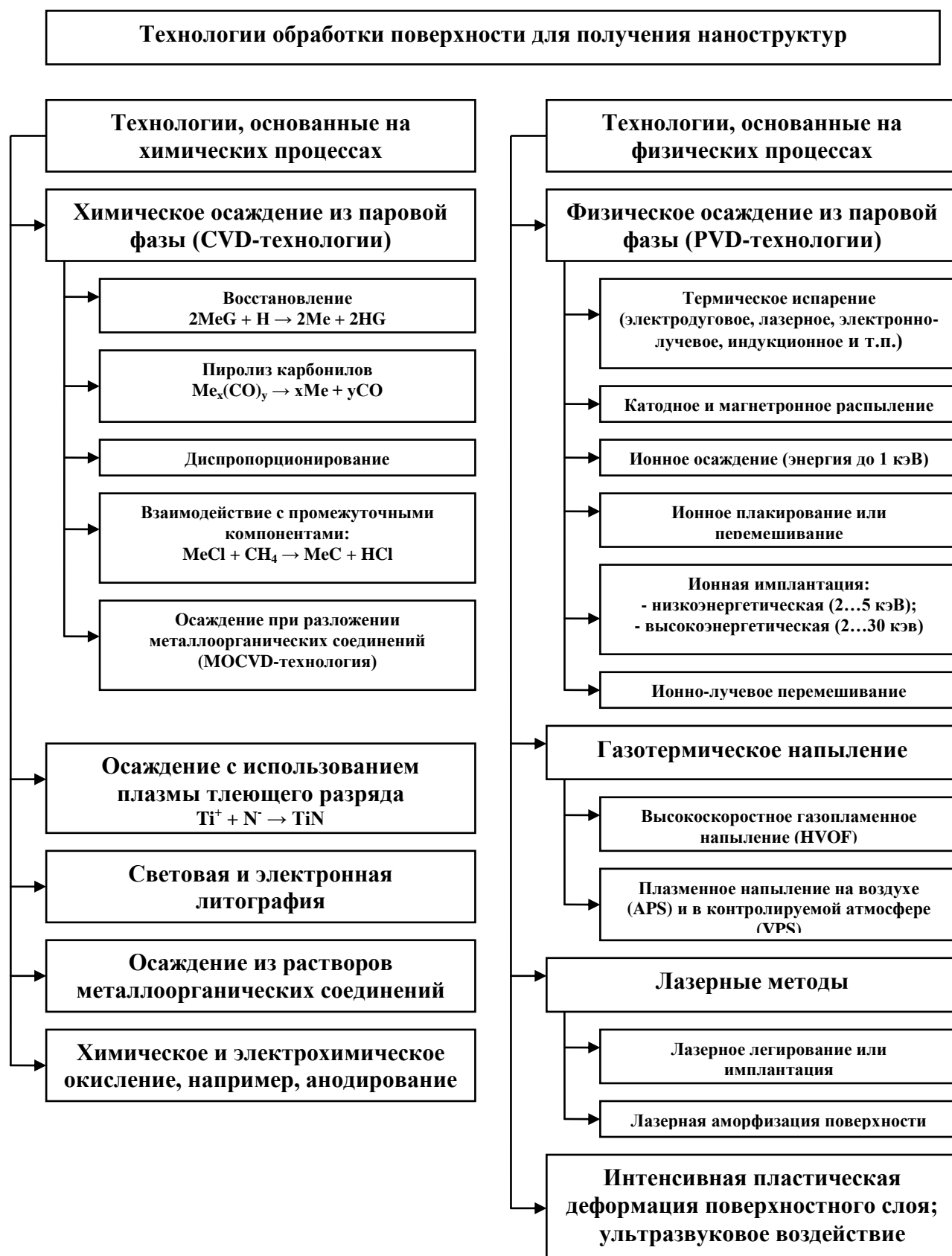
Рисунок 2.3.1 - Примерная классификационная схема nanoориентированных технологий обработки поверхности
