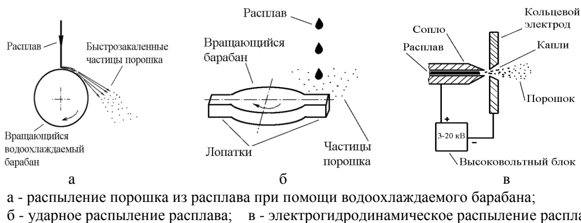
Рисунок 2.4 – Принципиальные схемы реализации различных методов распыления расплава при производстве нанопорошков
