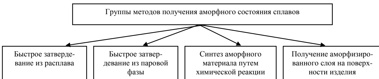
Рисунок 1.1 – Общая примерная классификация групп методов получения аморфного состояния металлических материалов
