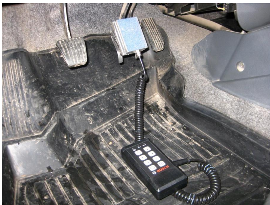
Рисунок 4 – Измерение усилия на педали тормоза
