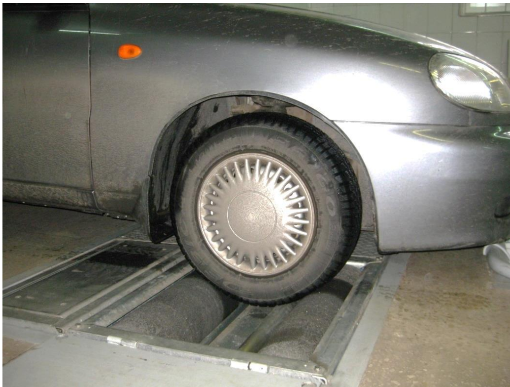
Рисунок 7 – Измерение тормозных сил передней оси
