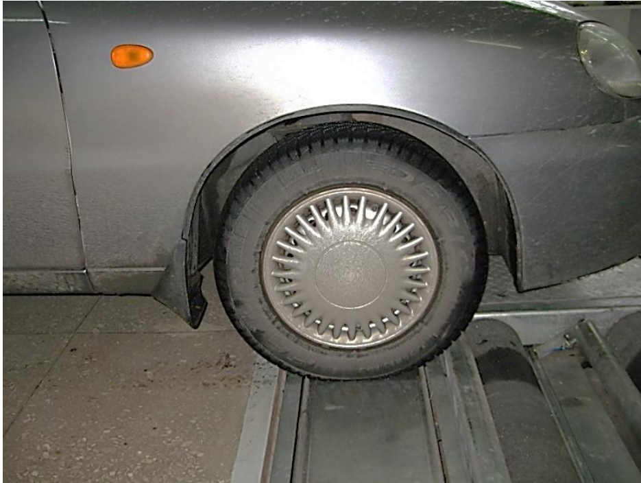
Рисунок 5 – Измерение статического веса автомобиля
