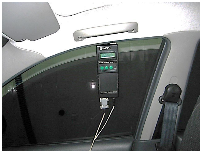
Рисунок 3 – Расположение прибора Эффект 02 в салоне автомобиля
