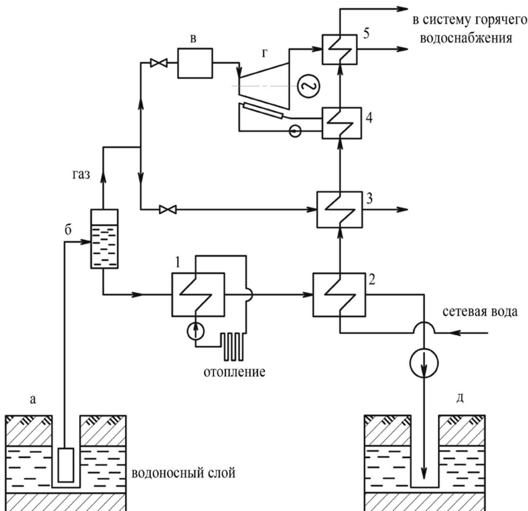
а) эксплуатационная скважина; б) сепаратор; в) камера сгорания; г) газотурбинная установка; д) нагнетательная скважина. Теплообменники: 1) системы отопления; 2) системы горячего водоснабжения; 3) газового котла; 4) системы охлаждения газотурбинной установки; 5) системы выхлопных газов.
