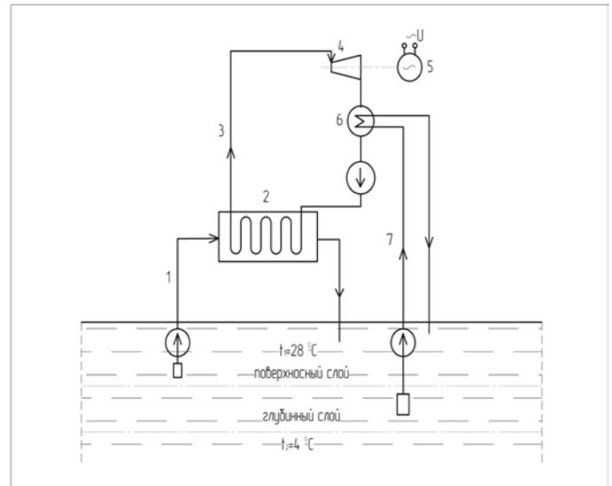
Рисунок 4.1 – Схема океанической ТЭС
