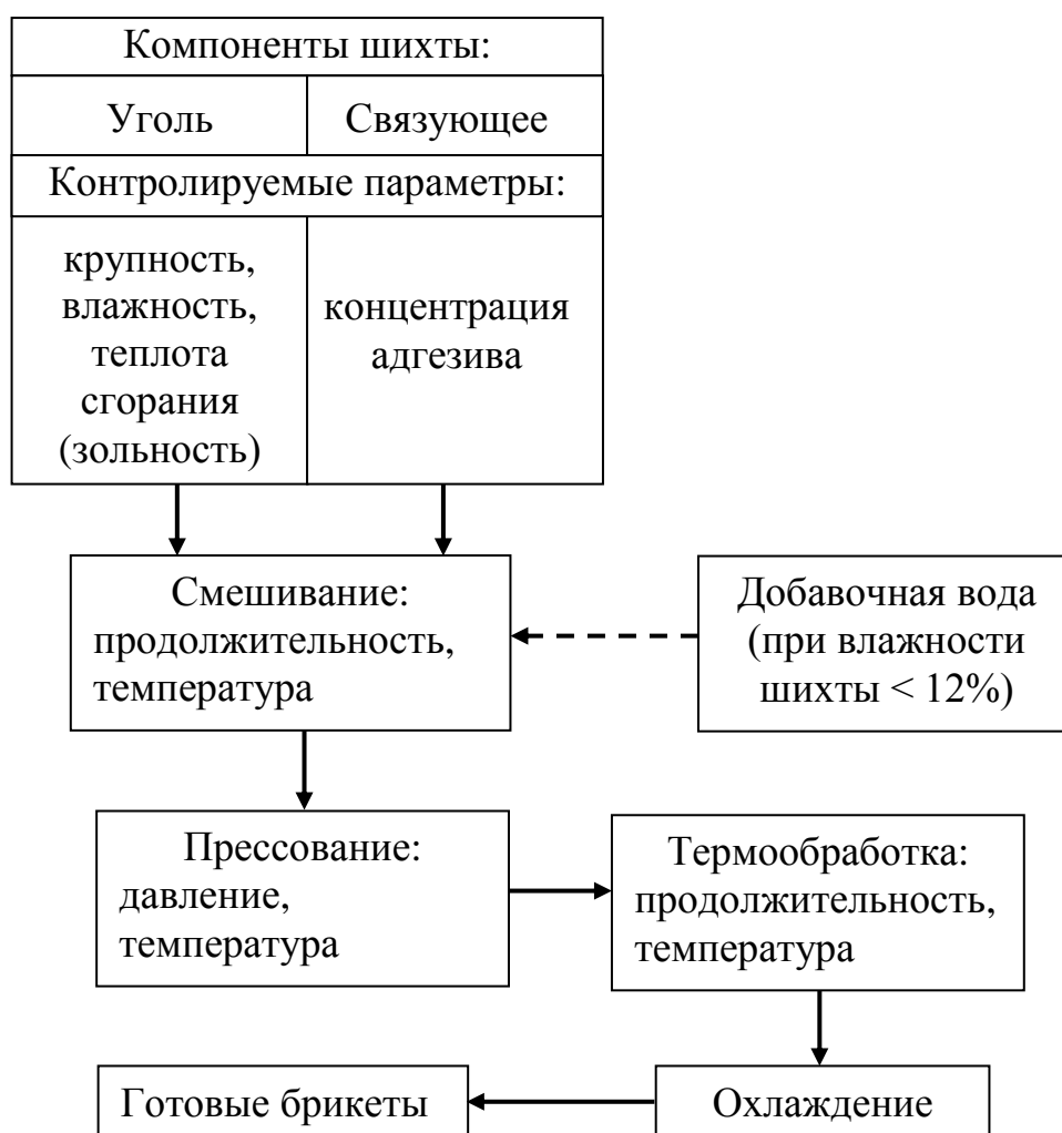
Рисунок 5.23 – Структурная схема процесса подготовки однокомпонентной шихты, брикетирования и термообработки при использовании водорастворимых связующих
