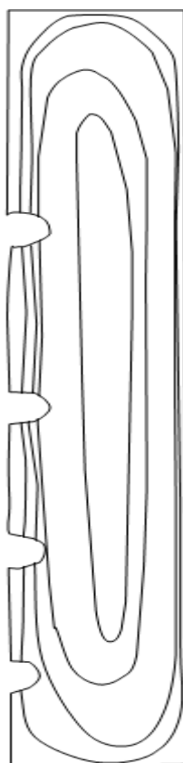
Рис. 4.18. Осесимметричное распределение линий тока в расплаве металла при всплывании пузырей аргона
