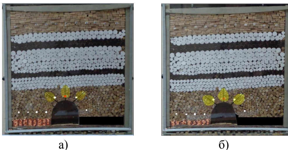
Рис. 4. Общий вид модели № 3 на начальном и конечном этапах нагружения для средней части выработки (репер № 6)
