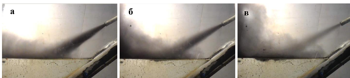
Рисунок 6. Характер взаимодействия с поверхностью жидкой ванны газопорошковой струи при различной плотности частиц вдуваемого материала
