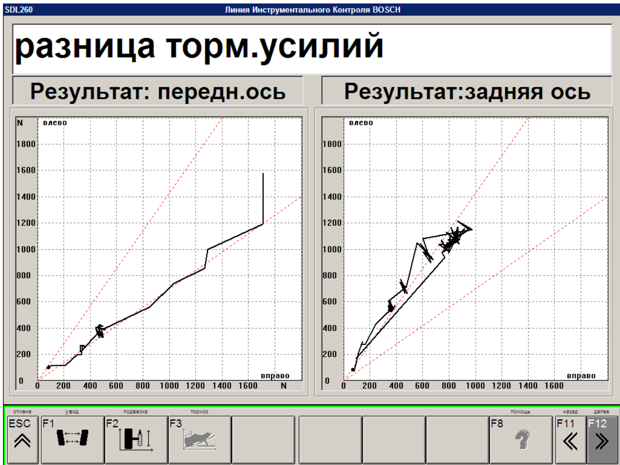
Рисунок 3 – Результаты измерения разницы тормозных усилий передней и задней оси автомобиля категории М 1
