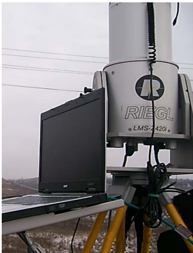
Рисунок 1 – Riegl LMS-Z420i- лазерная система
