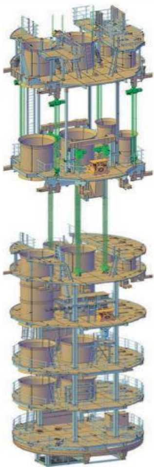
Рис.4. - Многоэтажный «шагающий» проходческий полк.
