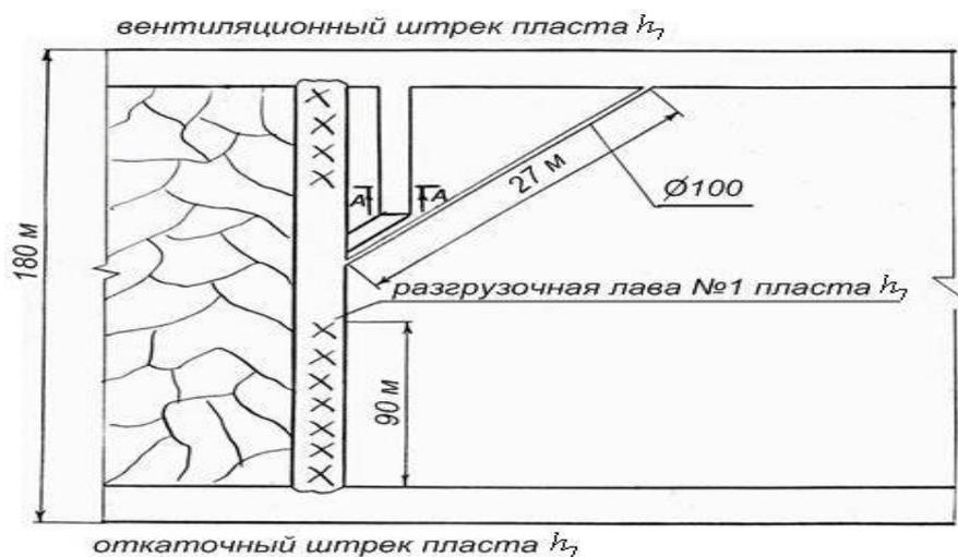
**Рис.2.** - Расположение скважины жизнеобеспечения и спасательной выработки при ликвидации аварии на ш. им. Горького ДУЭК
