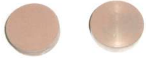
Рисунок 3 – Полученные заготовки на машине для прессования
