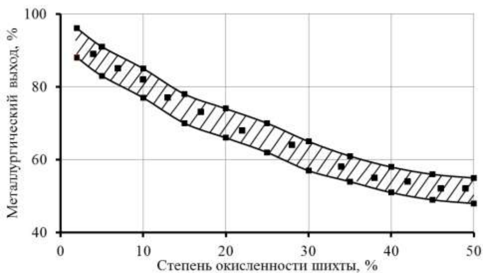
Рисунок 1 – Влияние степени окисленности отходов алюминиевых сплавов на металлургический выход при плавке с 8% флюса
