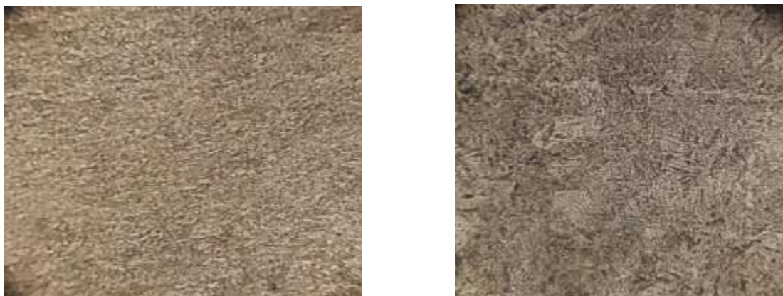
Рисунок 1 – Микроструктура катаной и закаленной проволоки из стали 20X13, х500
