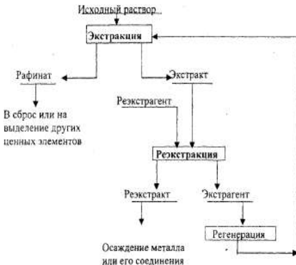
Рисунок 1 - Принципиальная схема экстракционного извлечения металла из раствора
