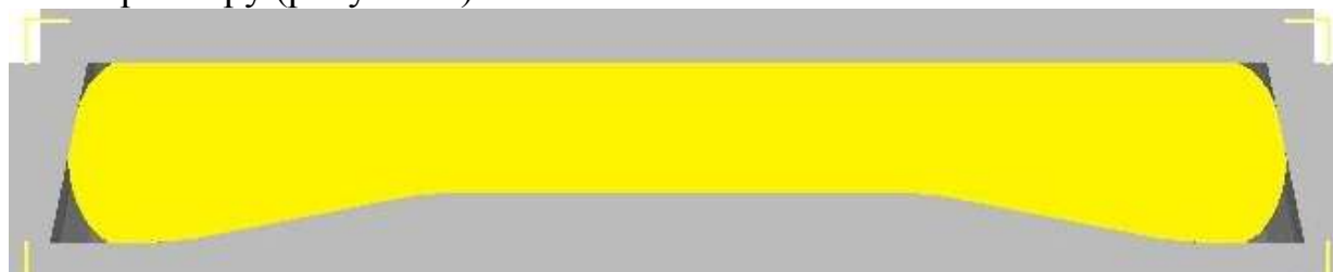
Рисунок 1 – Схема штамповки по предлагаемой технологии с нижней конусной плитой
