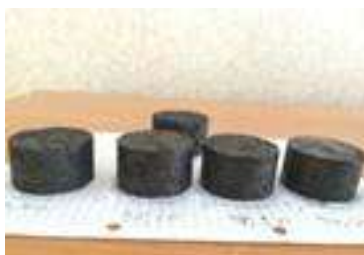
Рисунок 1 – Брикетты, спрессованные из металлизированной мелочи и шлама
