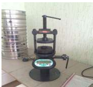
Рисунок 2 – Пресс для проведения исследования брикеттов на сжатие
