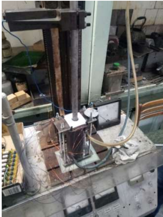
Рисунок 1 – Лабораторная установка электрошлакового переплава
