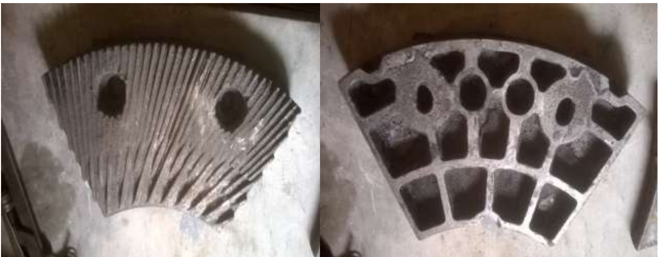
Рисунок 5 – Литая(ЛГМ) заготовка, сектора размалывающего D31-KF
