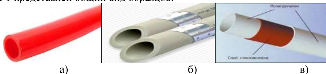
Рисунок 1 – Общий вид образцов: а) сшитый полиэтилен, б) металлопластик, в) полипропилен, армированный стекловолокном
