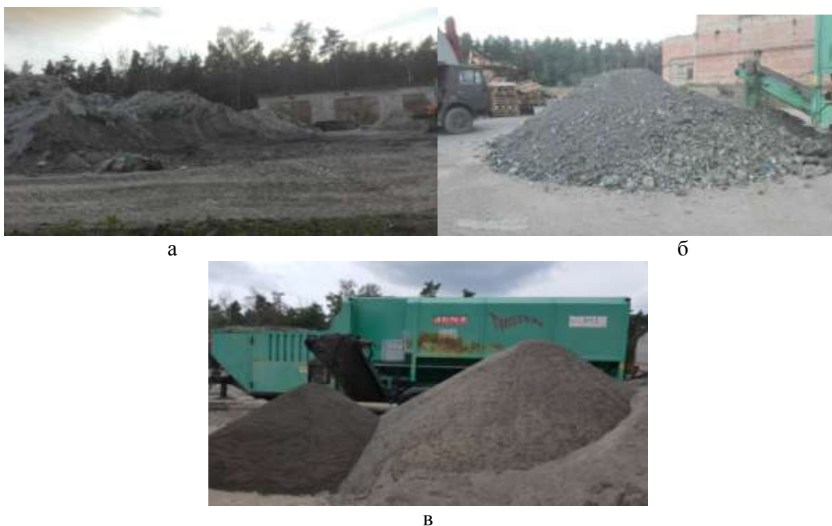
Рисунок 1 – Рассев отвального шлака на производственной площадке НПФ «Металлон»: а – ОПВА до отсева; б – крупная составляющая шлака после отсева; в – просев ОПВА с фракцией 8 мм
