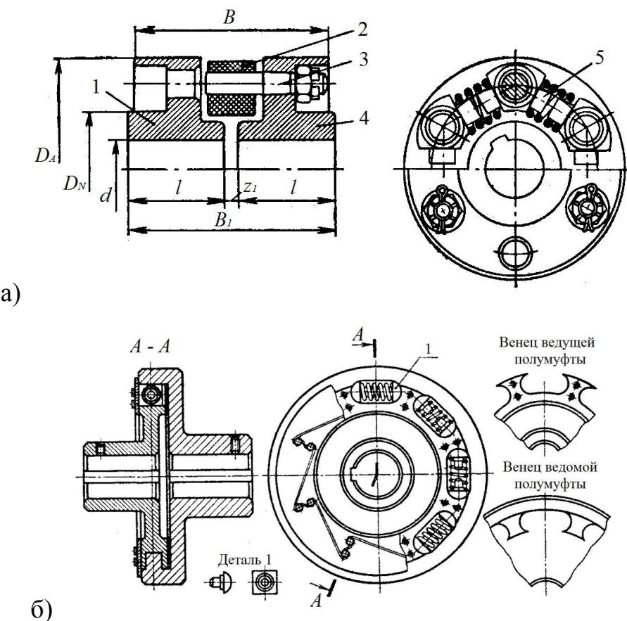
Рисунок 4 – Варианты упругой муфты с винтовыми пружинами:
