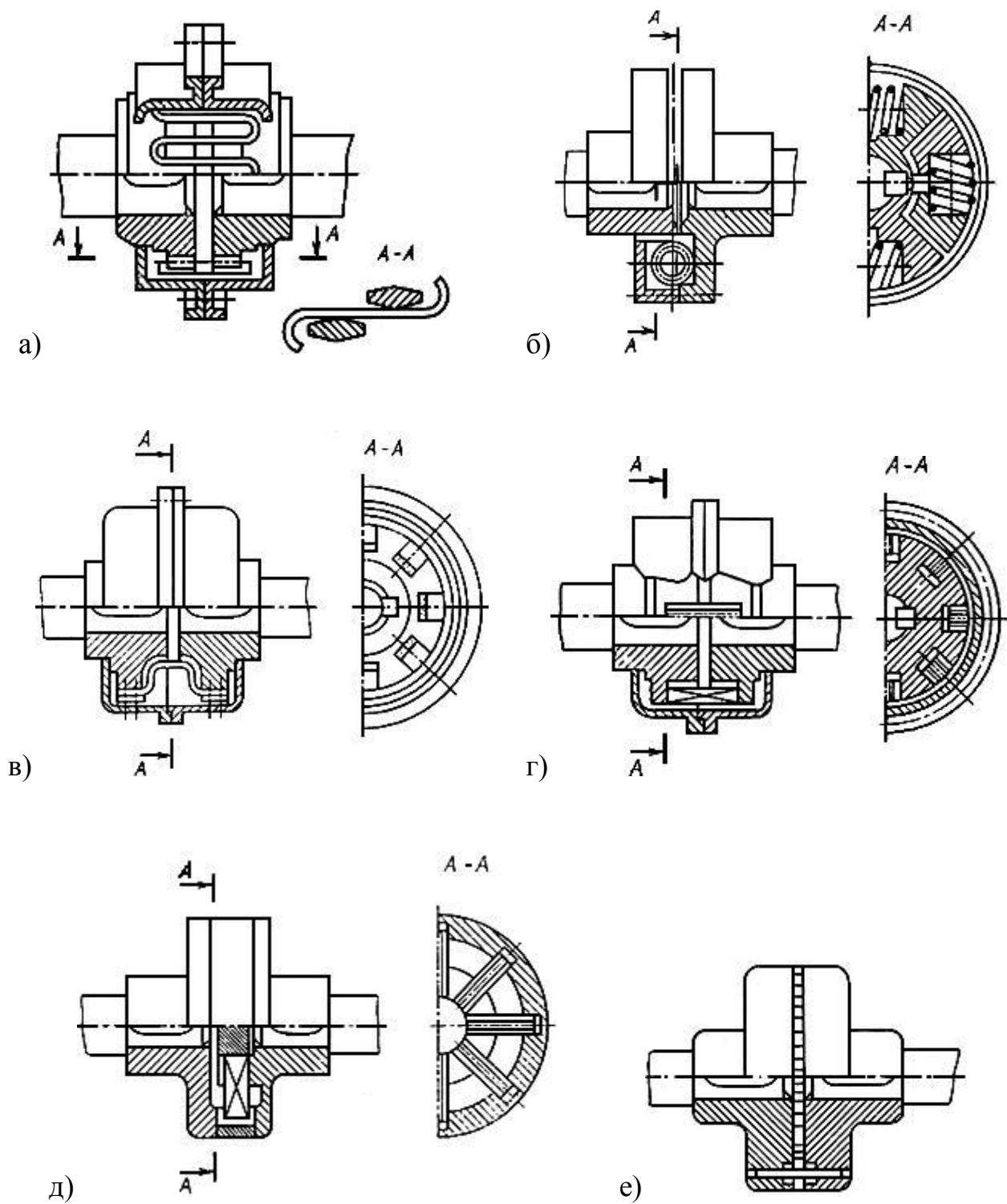
Рисунок 3 - Линейные упругие муфты с металлическими упругими элементами:
