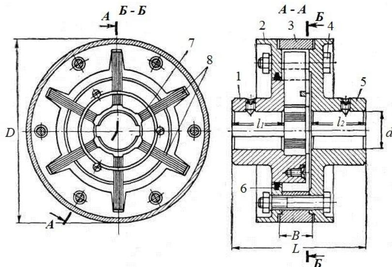
Рисунок 6 - Муфта с радиальными пакетами пружин
