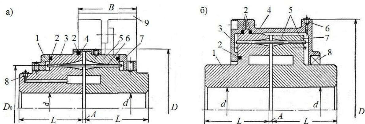
Рисунок 5 - Варианты исполнения муфты «Форст»
