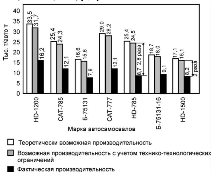
Рис. 1. Годовая производительность автосамосвалов
