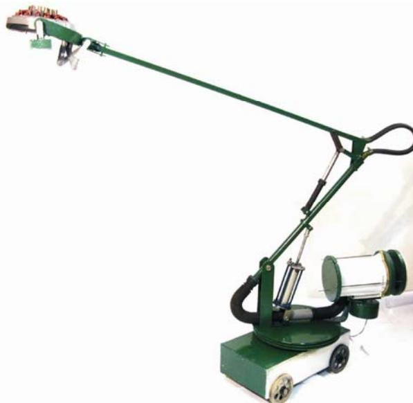
**Рис. 4.** Физическая модель новой вентиляторной системы проветривания карьеров
