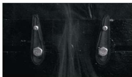
Рис. 6. Поля скоростей газозвдушного потока на различном удалении от выхода горловины плоской модели вентиляторной системы (а) и его визуализированная картина в зоне формирования (б) при давлении 50 кПа и объемном расходе энергоносителя 8 л/мин
