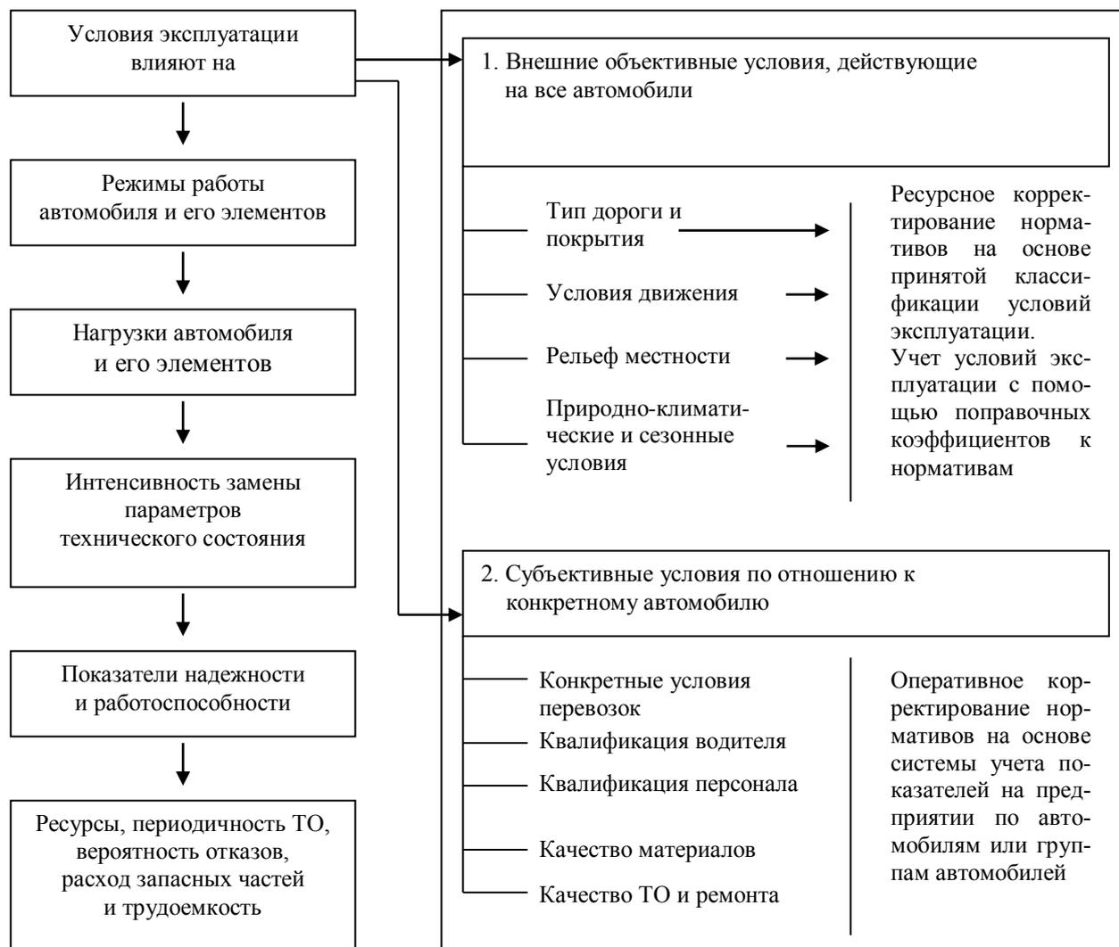
Рисунок 2 – Схема влияния условий эксплуатации на техническое состояние автомобиля и нормативы технического обслуживания и ремонта автомобилей
