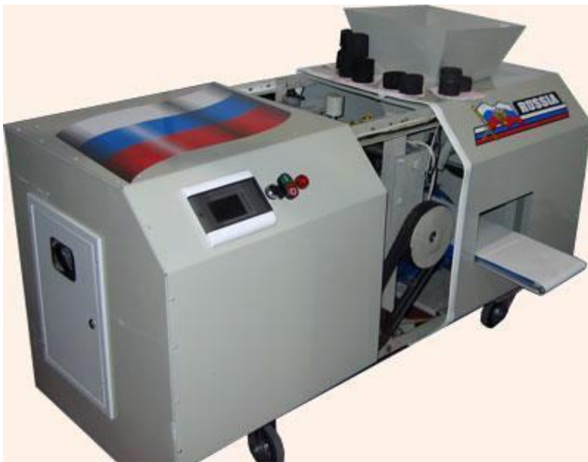
Рисунок 3 – Промышленное оборудование для брикетирования угля
