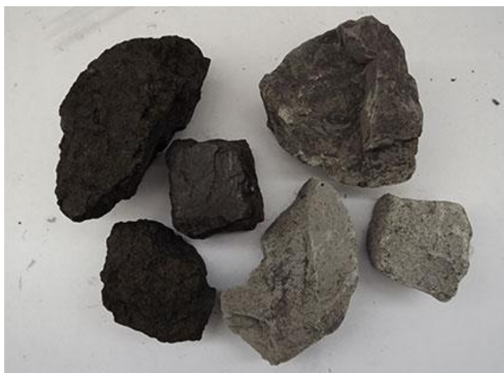
Рисунок 5 – Продукты сепарации бурого угля: концентрат (слева), отходы (справа)
