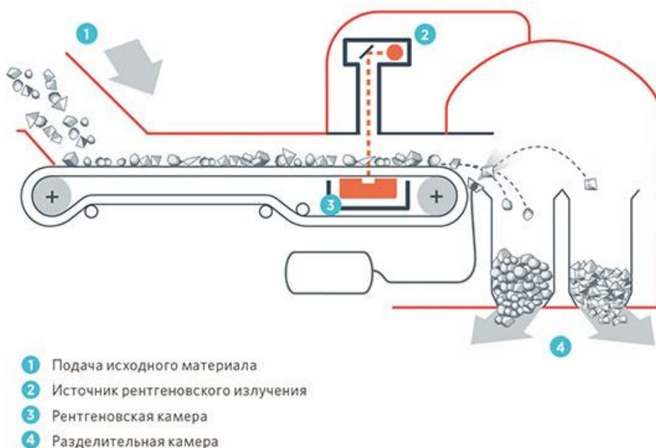
Рисунок 2 – Схема работы сепаратора TOMRA Sorting GmbH
