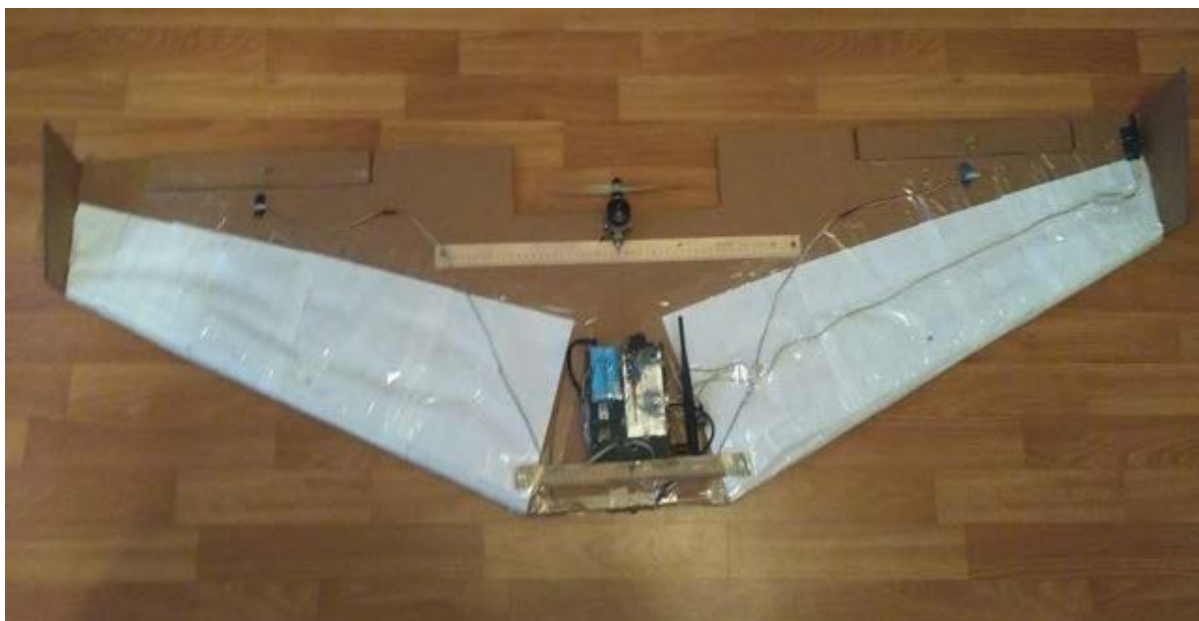
Рисунок 3 – Разработанный БПЛА из картона
