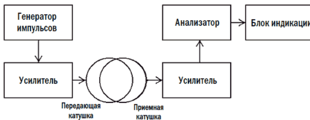
Рисунок 1 – Структурная схема импульсного металлоискателя
