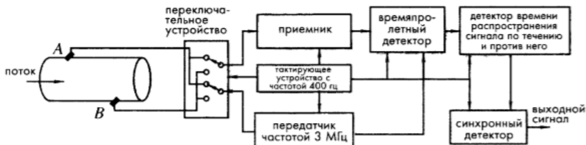
Рисунок 2 – Схема ультразвукового расходомера, в котором каждый кристалл играет роль и передатчика, и приемника
