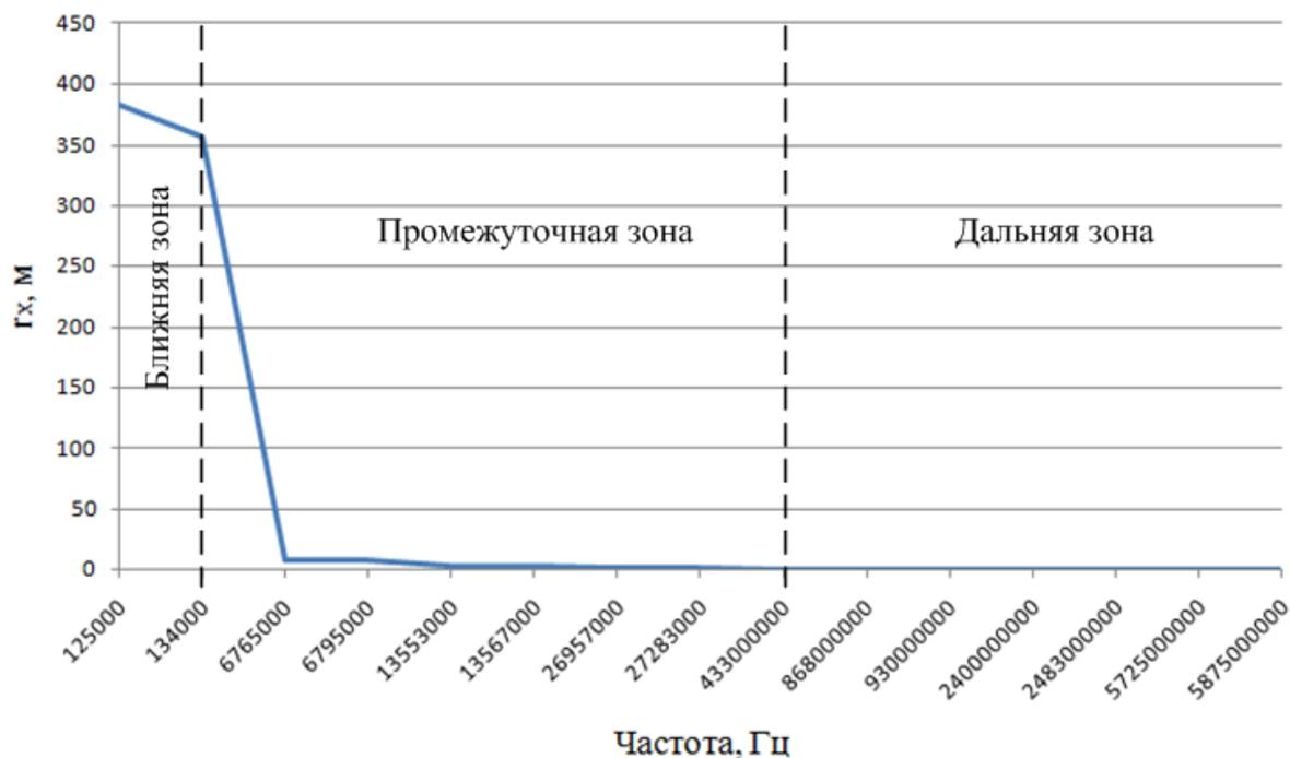
Рисунок 2 – Разделение частотного диапазона на зоны
