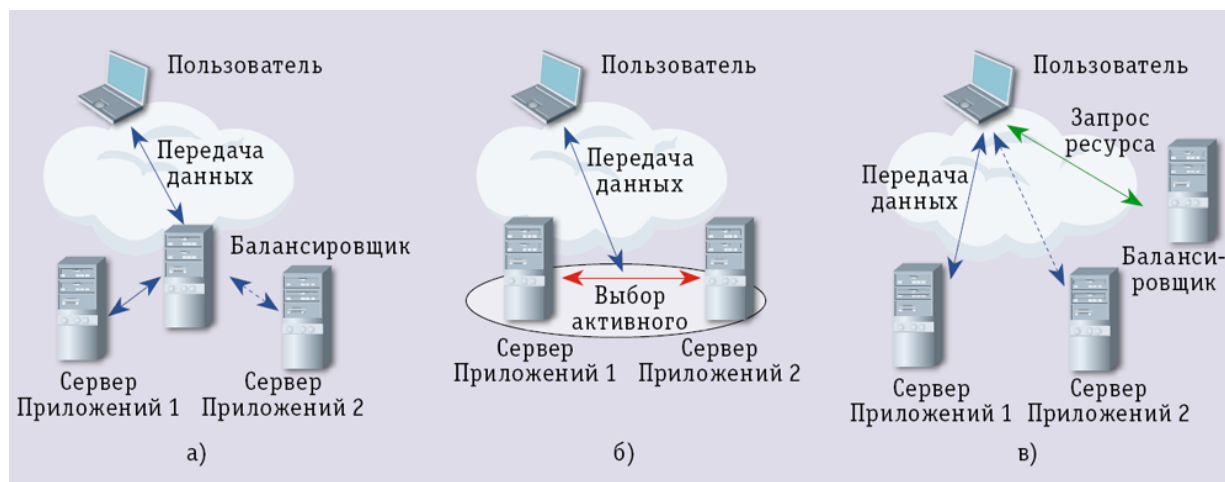
Рисунок 1 – Принципы балансировки нагрузки: а) балансировка с пропуском трафика через одно устройство балансировки; б) балансировка средствами кластера; в) балансировка без пропуска трафика через одно устройство балансировки
