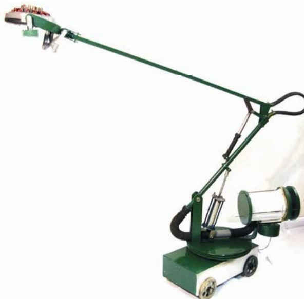
Рис. 4. Физическая модель новой вентиляторной системы проветривания карьеров
