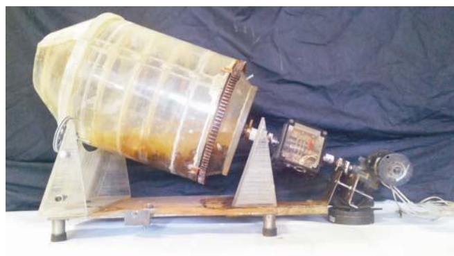
Рис. 5. Место размещения тензорезисторного преобразователя при контроле крутящего момента, необходимого для вращения корпуса модели конвертера
