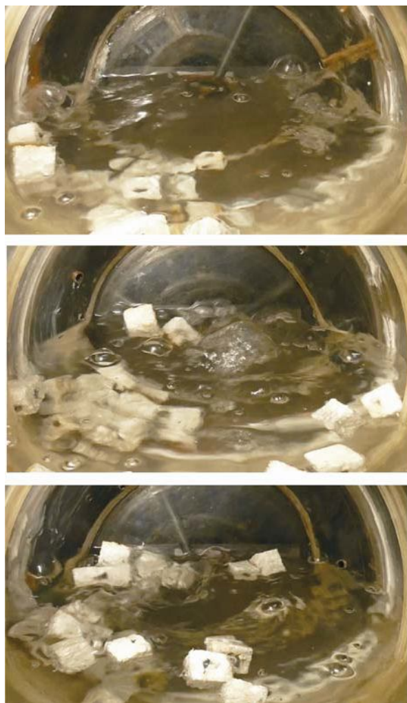
Рис. 5. Характерные картины взаимодействия твердой и жидкой фаз в ванне модели конвертера при комбинированном ее перемешивании
