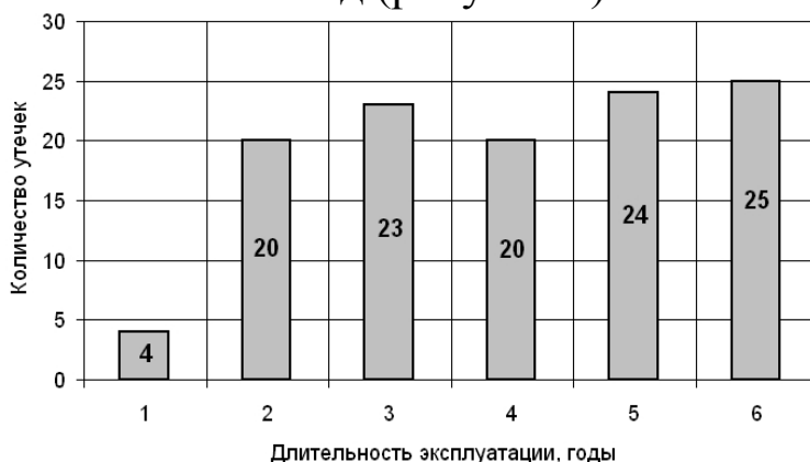
Рис. 4. – Изменение количества утечек в гидроприводе холодильника МНЛЗ
