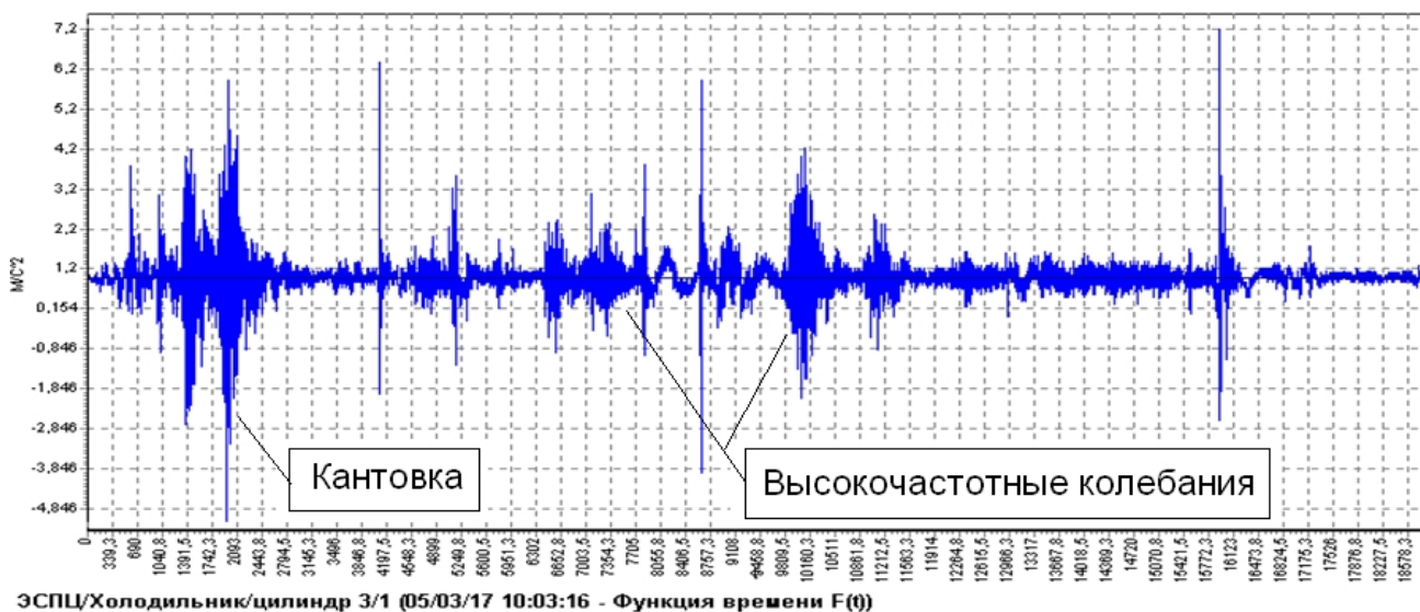
Рис. 7. – Временной сигнал виброускорения по гидроцилиндру №3 вертикального перемещения
