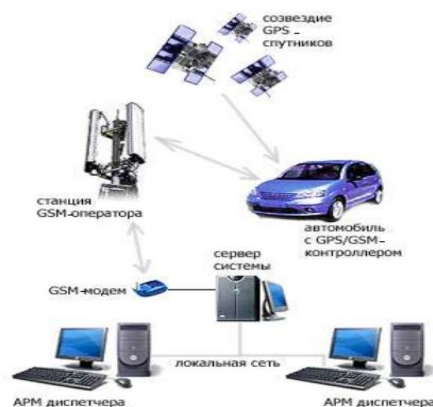
Рисунок 2. Схема доставки данных о местоположении автомобиля с помощью сотовой связи и собственного диспетчерского пункта
