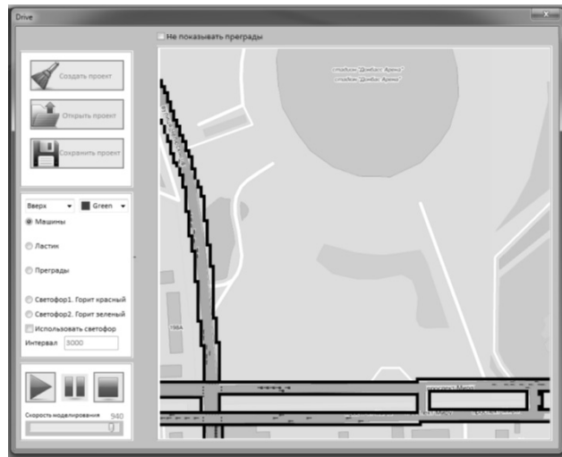
Рисунок 2 – Пример моделирование транспортных потоков, привязанный к реалиям города Донецка в районе Донбасс-арены
