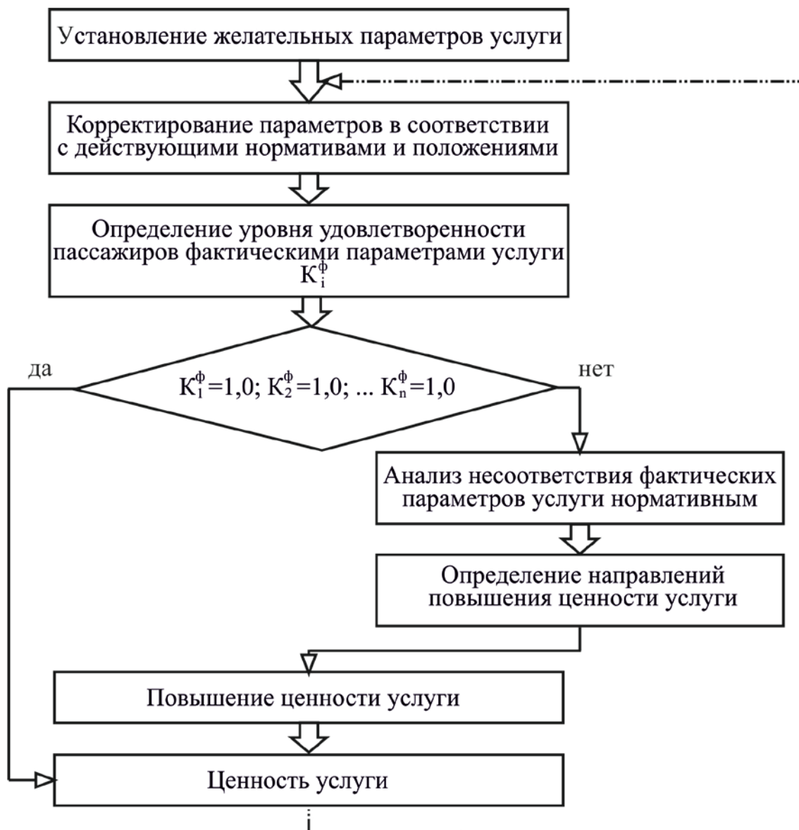
Рисунок 1 – Схема алгоритма процесса формирования ценности автотранспортных услуг в соответствии с требованиями пассажиров
