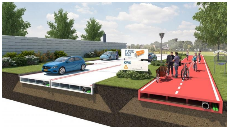
Фото 7 – Дорога, изготовленная из пластиковых бутылок.
