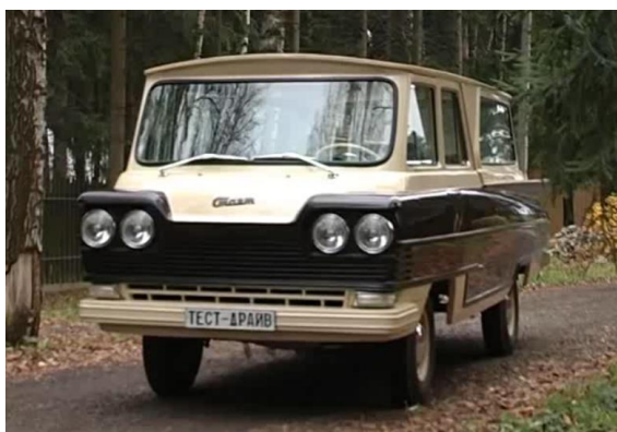
Фото 4 – Первый серийный отечественный микроавтобус «Старт» с пластиковым кузовом.
