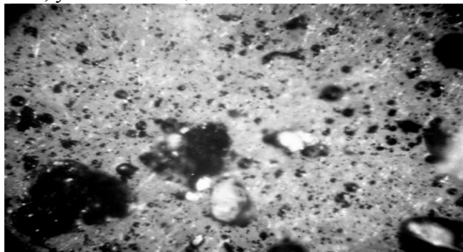
Рисунок 1 – Вид под микроскопом графитсодержащей пыли из бункеров циклонов ЦН-15 системы аспирации миксерного отделения ККЦ меткомбината «Азовсталь», увеличение в 18,5 раз.
