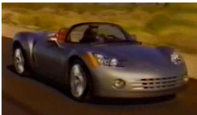
Фото 3 – Автомобиль «Chrysler-Pronto-Spyder» с кузовом из пластиковых бутылок.
