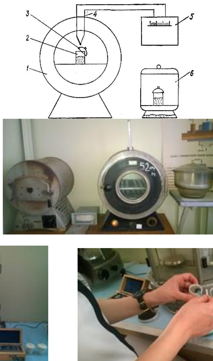
Рисунок 1 – Схема лабораторной установки для определения влажности топлива
