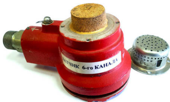
Рисунок 3 – Общий вид термокаталитического сенсора
