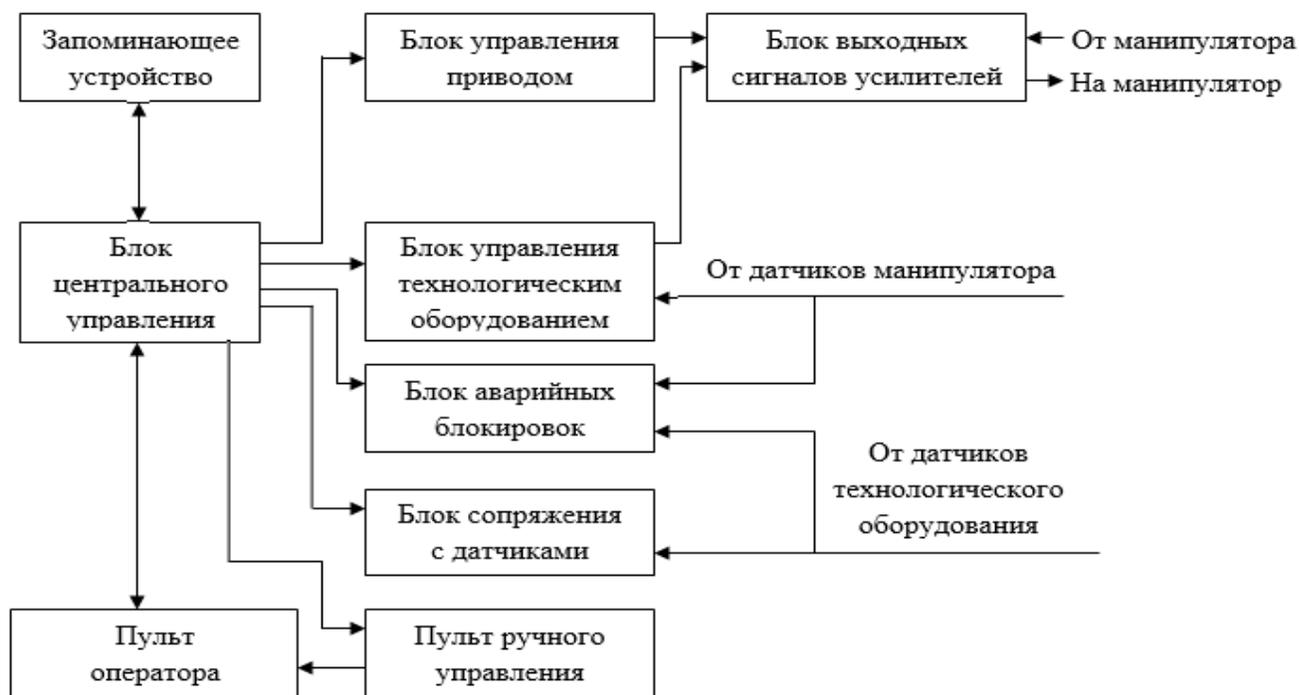
Рисунок 3 – Структурная схема циклового программного управления
