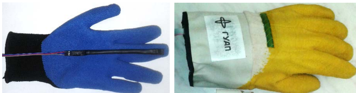
Рисунок 1 – Внешний вид перчатки с закрепленными на ней оптическими датчиками изгиба
