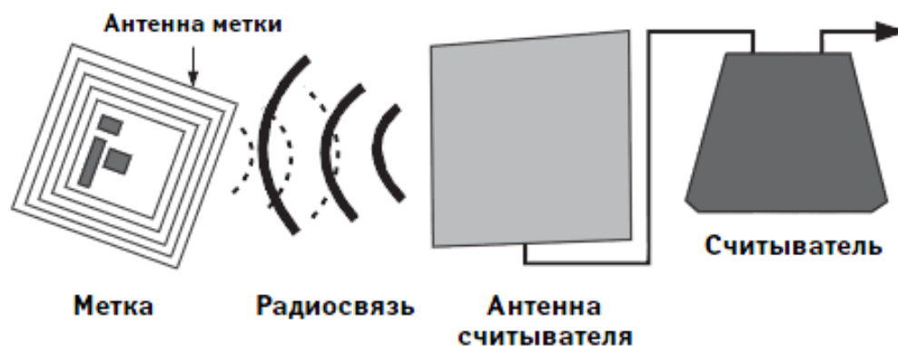
Рисунок 1 – Связь метки, считывателя и антенны
